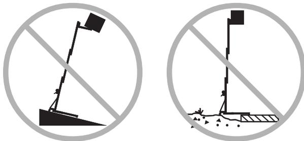
Vergewissern Sie sich vor dem Einsatz der Maschine, dass im Arbeitsbereich keine steilen Abhänge, Löcher, Schutt, instabiler oder rutschiger Untergrund oder ähnliche Gefahrenquellen vorhanden sind.
