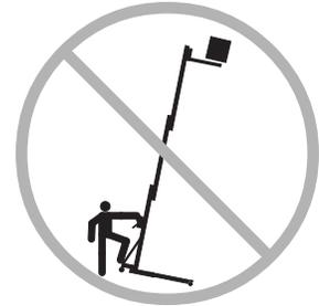
Abgesehen von geringfügigen Positionsänderungen darf die Maschine mit angehobener Ladung nicht bewegt werden.
