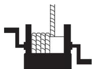
Verwenden Sie die Maschine nicht, wenn sich bei voll abgesenktem Schlitten weniger als vier Kabelwicklungen auf der Trommel der Winde befinden.
