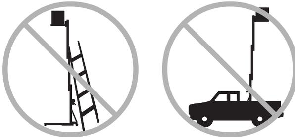
Die Maschine darf nicht auf einer beweglichen oder mobilen Fläche oder auf einem Fahrzeug eingesetzt werden.
