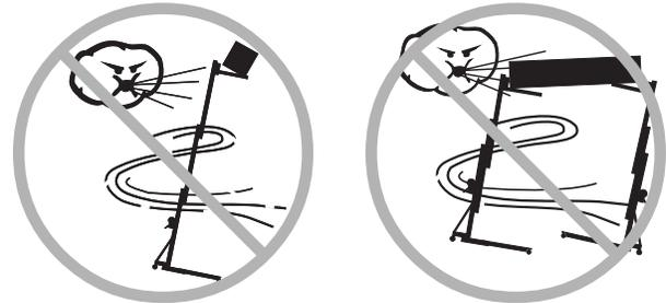
Bei starkem Wind darf die Ladung nur dann angehoben bleiben, wenn die Maschine ausreichend mit einem Halteseil gesichert ist.
