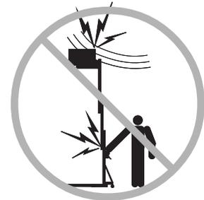
Halten Sie sich fern von der Maschine, wenn sie Strom führende Leitungen berührt. Die Maschine darf erst dann von Personen berührt oder in Betrieb genommen werden, wenn alle elektrischen Leitungen abgeschaltet sind.
