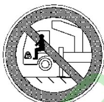
⇒ Im ausgehobenen Zustand muß das Fahrerhaus leer sein und lastfrei bleiben. D. h. bei ausgehobener Vorderachse ist der Aufenthalt im Fahrerhaus verboten! Zuladungen im Fahrerhaus bzw. zusätzliche Lasten oder Anbauten am Fahrerhaus sind ebenfalls verboten! Vorderauftritte dürfen nicht benutzt werden!
