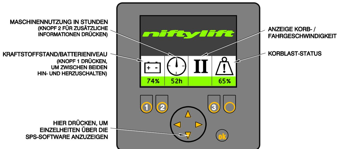
Außerdem wird auch ein Fehlercode angezeigt (siehe nachstehend), wenn das Steuersystem eine Fehlfunktion an der Maschine erkennt. Für weitere Informationen siehe **Anhang A**.
