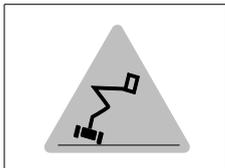
**MAX. Neigungswinkel überschritten:** Der Alarm ertönt und auf dem Display werden abwechselnd die hier gezeigten Bilder angezeigt. Ausleger in die Position Verstaub absenken und die Maschine auf ebenen Grund fahren, um vollständige Maschinenfunktion wieder herzustellen.
