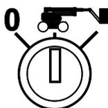
**Bodensteuerung:** Um die Plattformsteuerung zu aktivieren, muss der Auswahlschalter der Bodensteuerung im Uhrzeigersinn gedreht werden. (Siehe Abschnitt 4.2.1, Punkt 7)
